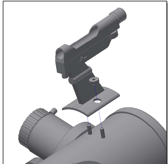
Figura 3. Coloque o buscador e fixe com as porcas
